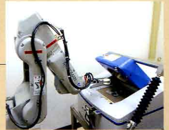
●自動分析装置 飛灰中の鉛濃度を自動で測定し、薬品注入量を適切にコントロールします。
