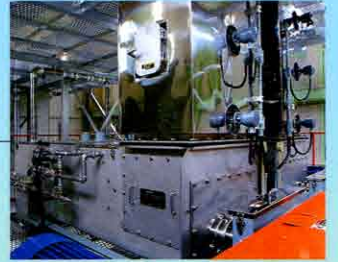
●混練機 飛灰に薬品（キレート剤）と水を加えて固形化し、重金属などの有害な物質が溶出しにくいように処理します。
